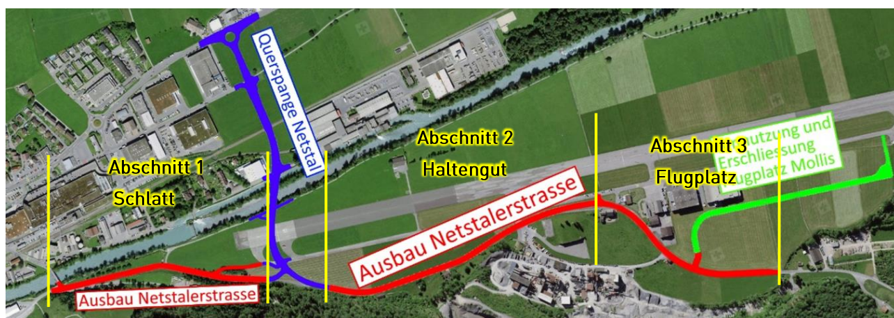
Abb. Nr. 1 Übersicht Projekt Ausbau Netstalerstrasse
